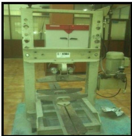
Gambar 3 *Milano Italy* (alat untuk menguji kuat lentur)
